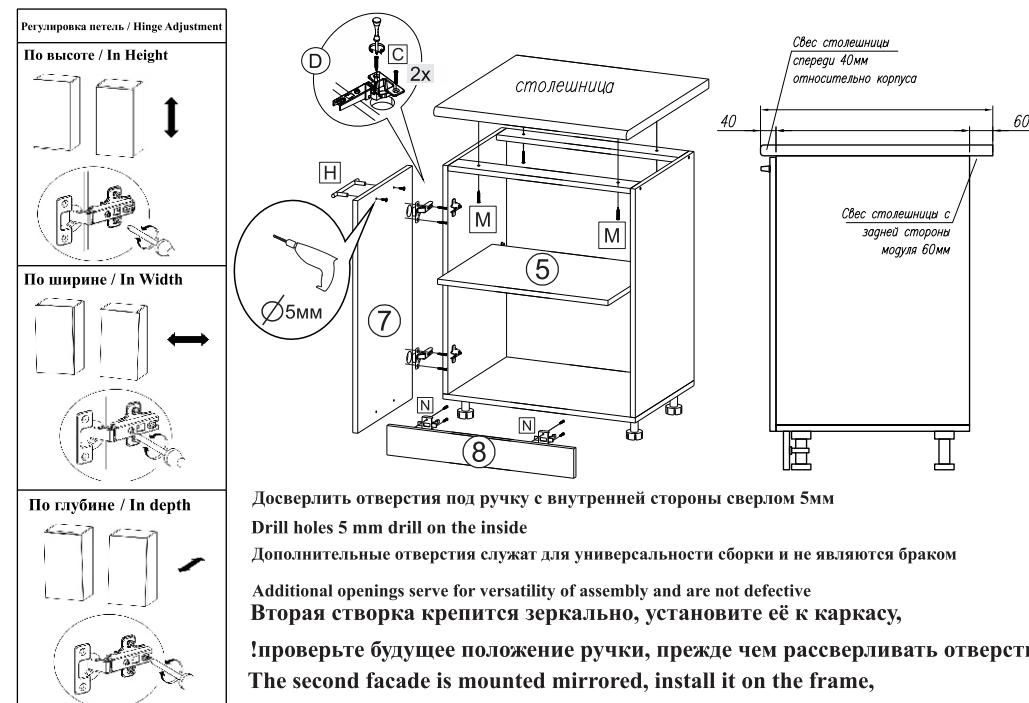
Досверлить отверстия под ручку с внутренней стороны сверлом 5мм
